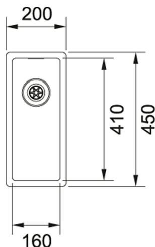
Ein Becken, drei Einbau-Lösungen: SlimTop, Flächenbündig, Unterbau – auf Wunsch mit Armaturenbank. Die 20 cm tiefen Edelstahlbecken decken nahezu alle planerischen Bedürfnisse ab. Der enge Radius von 12 mm betont die geradlinige, zeitlose Formensprache der Spüle und bietet maximales Volumen. Auch beim Vorbereiten vieler Portionen bleibt das Becken dank Integralablauf und verdecktem Überlauf immer picobello.
